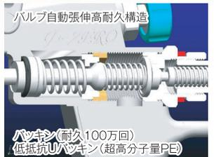
特許出願中 空気弁の動きにケーシングが追随しパッキン偏減りを防止。
