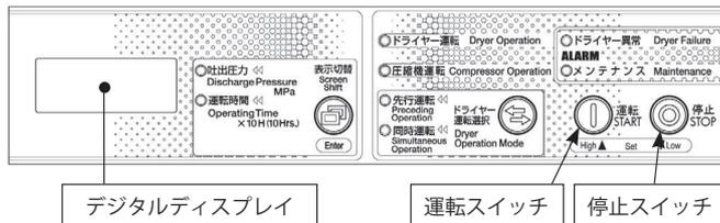
停電自動復帰の設定を行わなくても 3 秒後に圧力表示に戻ります。なお、停電自動復帰を設定した場合、DPFM55B,75B,110B (エアードライヤ内蔵・搭載型) は、エアードライヤの再起動保護のため電源復帰後、1 分間はエアードライヤが起動しません。エアードライヤが再起動するまでは圧縮機も起動しません。電源復帰後に圧縮機が再起動するまでの時間は下記ようになります。
